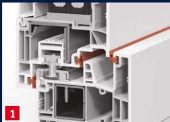
PaXabsolut 4 ist durch den dickwandigen Profilaufbau nicht nur äußerst stabil, sondern ebenso konstruiert für beste Wärmedämmwerte. Durch die drei umlaufenden Dichtungsebenen sind die Fenster besonders widerstandsfähig gegen äußere Einflüsse. Im neuen Profilsystem PaXabsolut 4 erreichen wir einen Uw-Wert von bis zu 0,74 W/(m²K). Das schafft energetische Vorteile in Verbindung mit unseren Wärmeschutzverglasungen.
